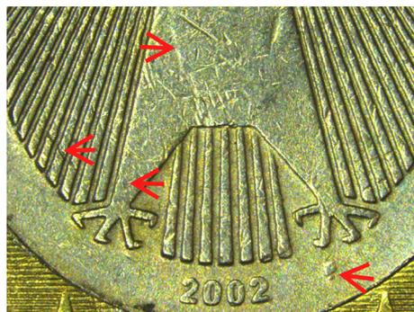
É também notório o desalinhamento do eixo vertical dos desenhos do anel exterior e do núcleo.
