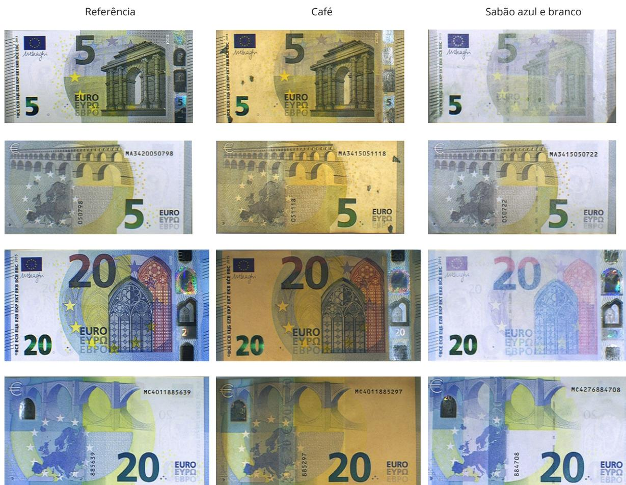
O resultado obtido com o vinagre (Figura 12) é um bom exemplo da influência do revestimento na proteção das notas. A nota de 20 euros, sem revestimento, apresenta degradação homogénea de coloração amarelada em toda a superfície, enquanto a nota de 5 euros apenas mostra pequenos pontos castanhos. A camada de revestimento (verniz) que cobre toda a superfície da nota de 5 euros protege-a do efeito do vinagre, que só ataca nos pontos de quebra desse revestimento.
