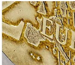
Comparando com a moeda suspeita de contrafação (exemplo) verifica-se que a superfície do mapa é composta por um relevo diferente – “relevo positivo”. Adicionalmente, a superfície da moeda apresenta diversos pontos em relevo positivo dispersos que permitem evidenciar os defeitos dos equipamentos utilizados pelo contrafator.
