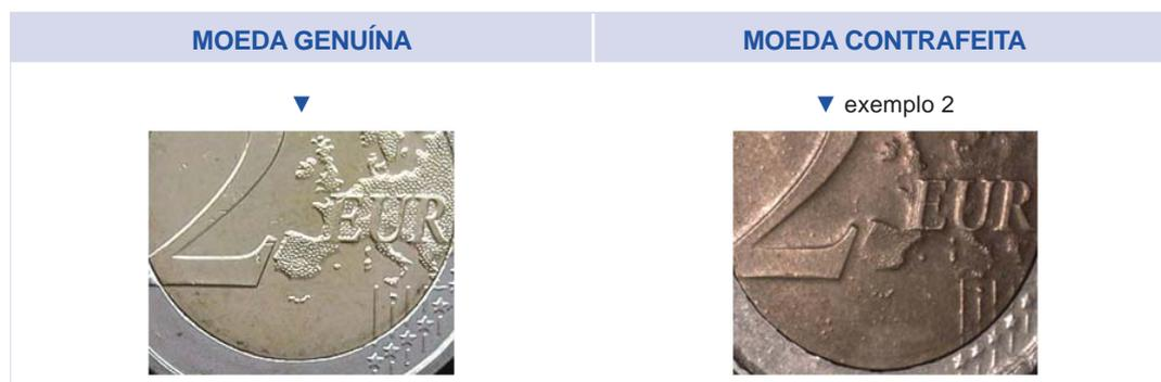
Na comparação entre a superfície da moeda genuína e o exemplo da contrafação observam-se diversas irregularidades no desenho, destacando-se os diversos pontos em relevo positivo espalhados pela superfície da face comum.
