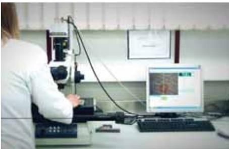
Para tal, por cada lote de notas finalizadas, é retirada uma amostra a qual é submetida a diversos testes laboratoriais, tais como, a medição das propriedades infravermelhas, ultravioletas, e magnéticas, a medição do relevo da impressão Intaglio e a análise da resistência das notas a condições extremas de utilização.
