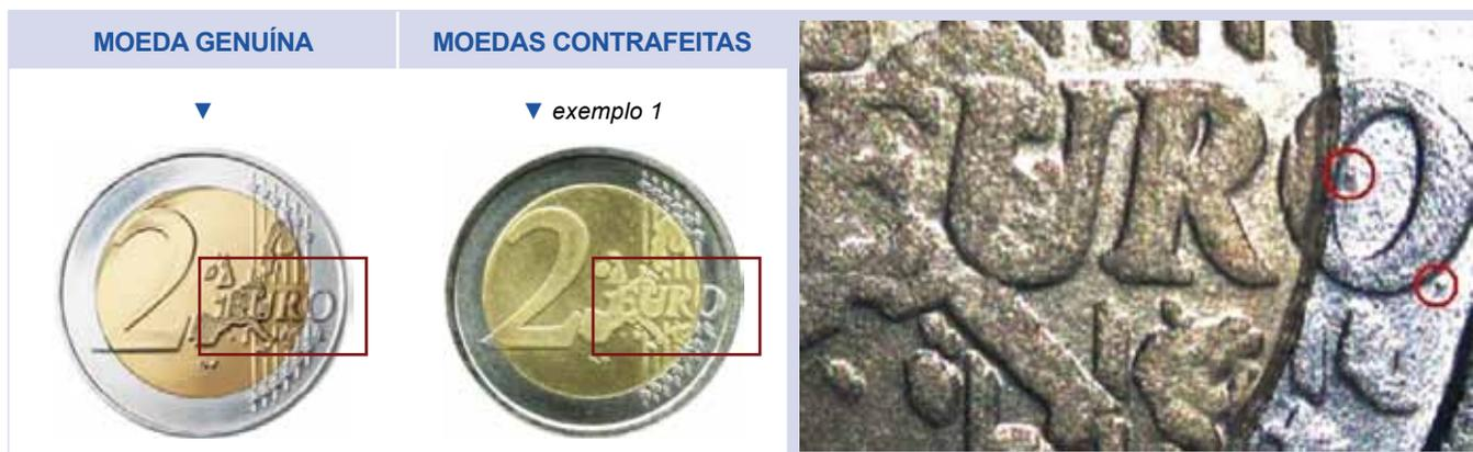
Ao observarmos a contrafacção com o auxílio de uma pequena lupa, verifica-se a existência de pequenos pontos em relevo positivo na superfície da moeda, o que denota excesso de material e imperfeições no cunho utilizado pelos contrafactores.
